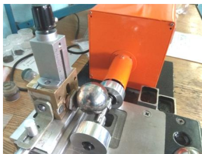
Рисунок 1. Фото внешнего вида устройства по определению износостойкости
